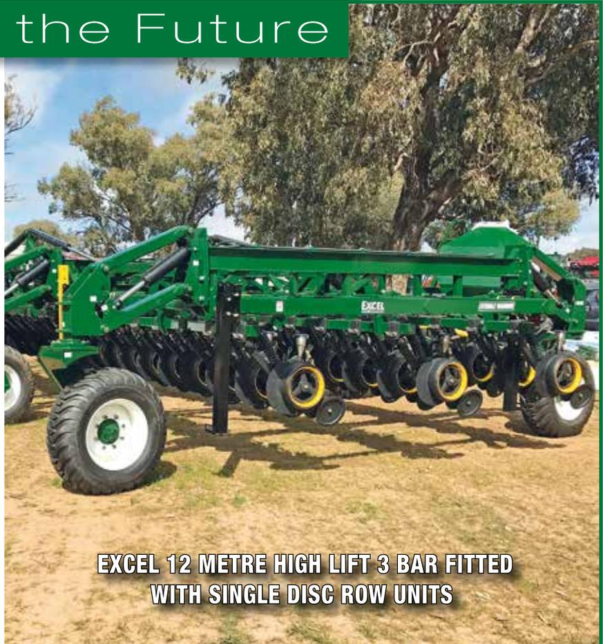
**EXCEL 12 METRE HIGH LIFT 3 BAR FITTED WITH SINGLE DISC ROW UNITS**
